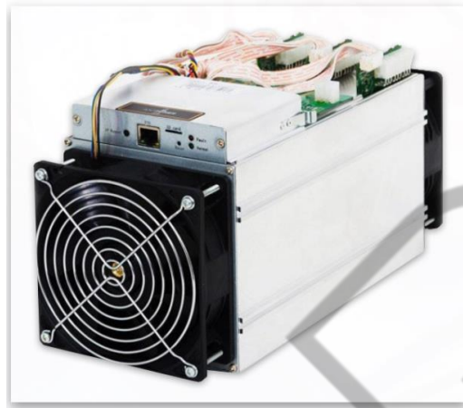
Figura 4.3 – Bitmain Antminer S9i Fonte: BITMAIN (s.d.)
